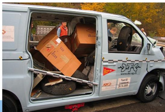
Côté conducteur – arrimage de sécurité, côté passager pas d'arrimage (500 kg/50 km/h)
