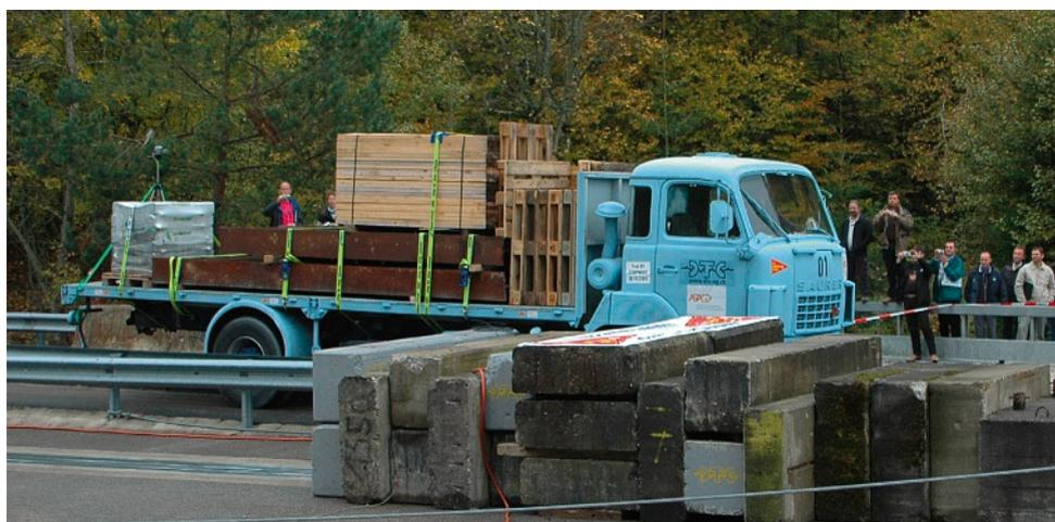
Arrimage de sécurité renforcé avec des sangles (6 t/50 km/h)
